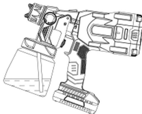
а) При распылении в восходящем направлении скошенный край всасывающей трубки должен быть направлен к задней части краскораспылителя.
