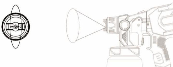
9) Включите выключатель питания, нажмите на спусковой механизм, краска начнет распыляться из дюзы.
