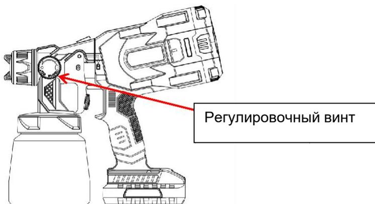
7) Регулирование длины струи распыления: Поверните эту ручку, чтобы изменить форму пятна с вертикальной на горизонтальную.
