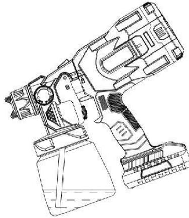
б) При распылении в нисходящем направлении скошенный край всасывающей трубки должен быть направлен к передней части краскораспылителя.
